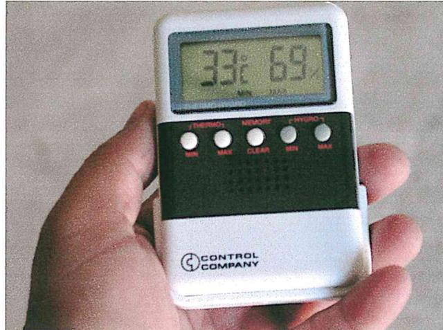
Fig. 3. Termohidrómetro utilizado para medir humedad y temperatura en los sitios de experimentación.
