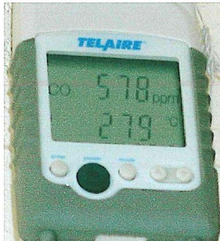
Fig. 10. Medidor de CO<sub>2</sub> y temperatura
