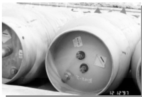
Foto 4: Vista de las válvulas de acceso de las botellas pequeñas que contienen HFC-134a.
