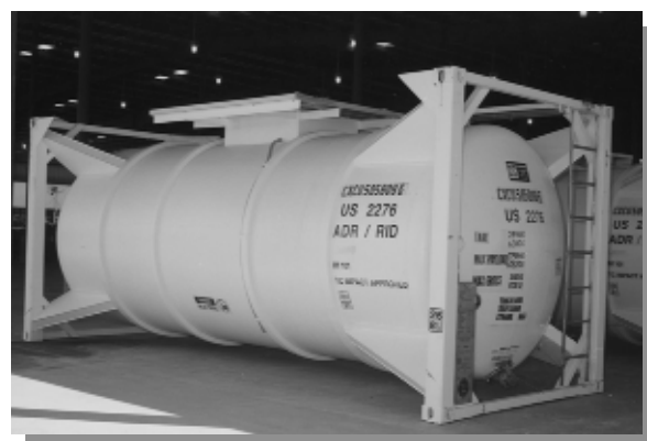
Foto 24: Los tanques ISO permiten el transporte multimodal de grandes cantidades de refrigerantes.
